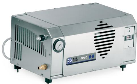
AR PRO BC 1240 est le nettoyeur eau froide poste fixe professionnel de la gamme intensive Avanteam le plus puissant. Sa conception, trois pistons céramique associés à une culasse laiton, en fait un appareil idéal pour un usage intensif.
