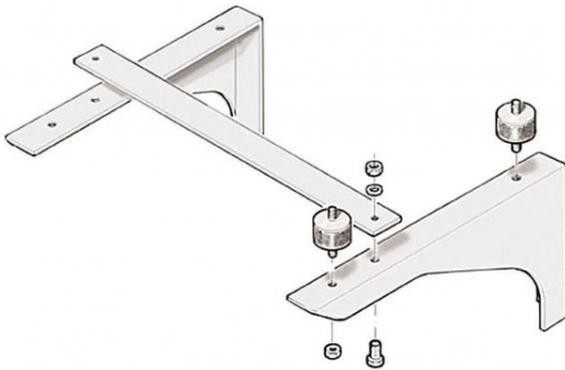
Support équerre pour installation du NHP en poste fixe sur une paroi verticale dans un local.
