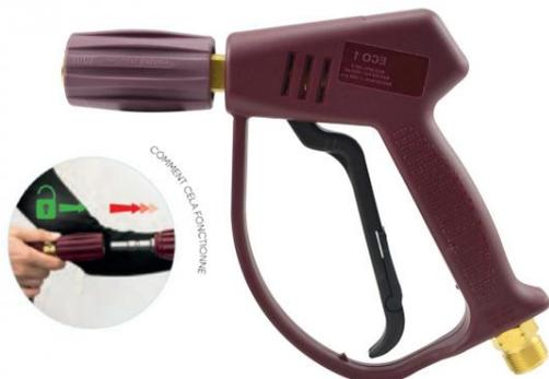
Poignée pistolet en laiton avec coque de protection en PVC. Montée sur une lance ou un autre accessoire, elle permet un changement rapide et sans outil, optimisant ainsi l'utilisation. Le système de raccord rotatif évite que le flexible haute pression ne se vrille pendant la manipulation et facilite son enroulement pour le rangement.
