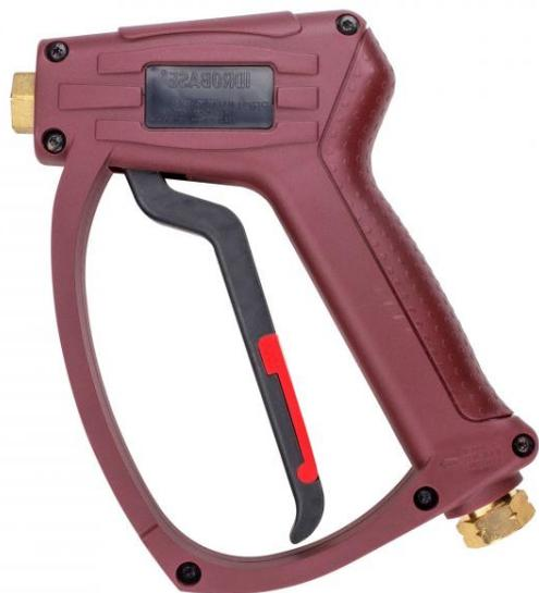
Poignée pistolet en laiton avec coque protection en pvc. Cette poignée quand elle est montée sur un flexible HP, permet la rotation du flexible même sous pression et ainsi optimiser l'utilisation. Son système de raccord rotatif permet d'éviter que le flexible HP ne se vrille pendant la manipulation. Il permet également un enroulement facile du flexible HP pour le rangement.
